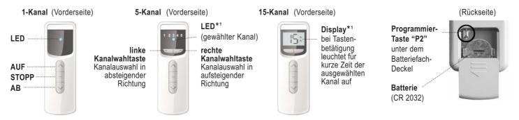
\*1 die Mehrkanal-Handsender (5- und 15-Kanal) verfügen zusätzlich über einen Gruppenkanal: Dieser Gruppenkanal ermöglicht die gleichzeitige Ansteuerung aller Motore bzw. Empfänger, die auf den einzelnen Kanälen eingelernt worden sind. Eine gezieltes Einlernen bzw. Programmieren des Gruppenkanals ist nicht möglich! Der Gruppenkanal ist ausgewählt, wenn beim 5-Kanal Handsender alle 5 LED's kurz aufleuchten und beim 15-Kanal Handsender die Zahl "0" im Display für kurze Zeit erscheint.
