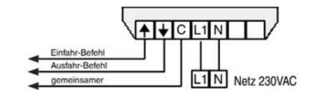
Bei Ansteuerung von dezentralen Steuerungen, wie z.B. MC P2, MC P4
